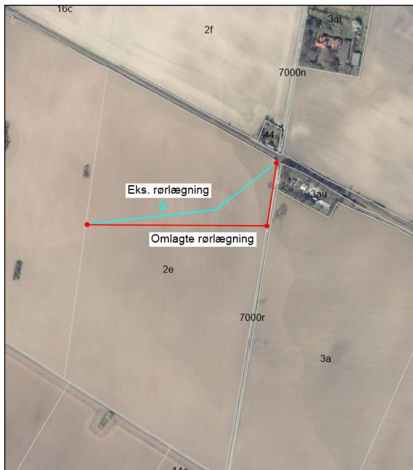
Billede 2 Kort der viser ca. placering af den eksisterende rørlægning (blå) og den ønskede omlægning (rød).
