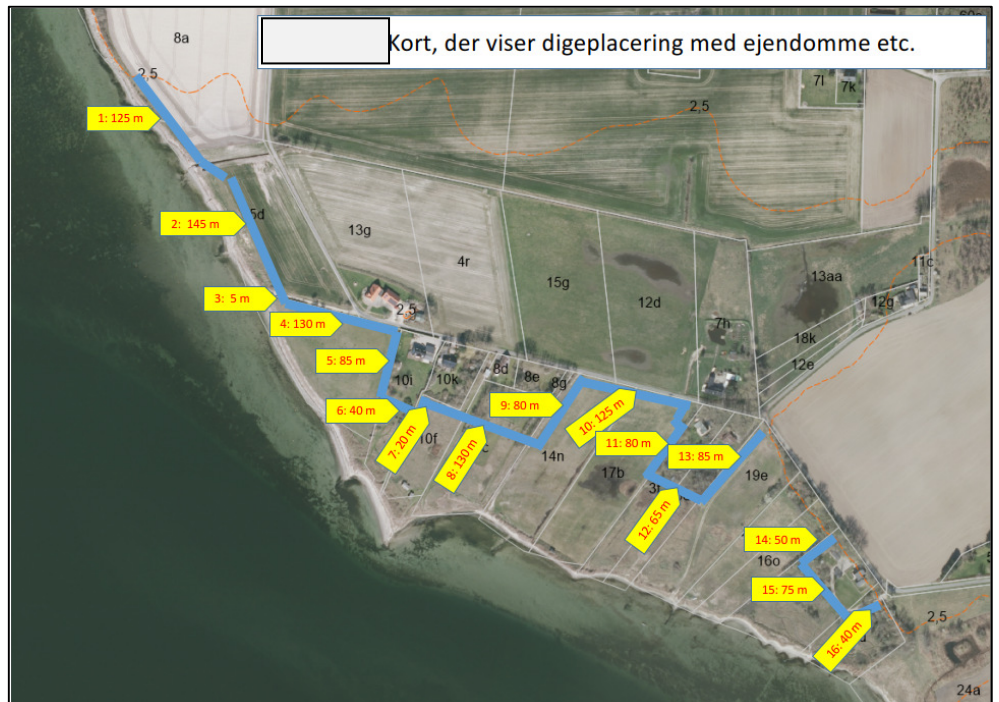
Kort A2 – Kort med kystbeskyttelsesplanlægningens placering og forløb ved nord-vest Falster angivet med blå streg samt markering af delstrækninger. De gule pile angiver nummerering af delstrækninger samt en angivelse af delstrækningens ca. længde. Illustration af fæstning på kote 2,5 meter DVR90 mod nord (udarbejdet af ansøgerrepræsentant).
