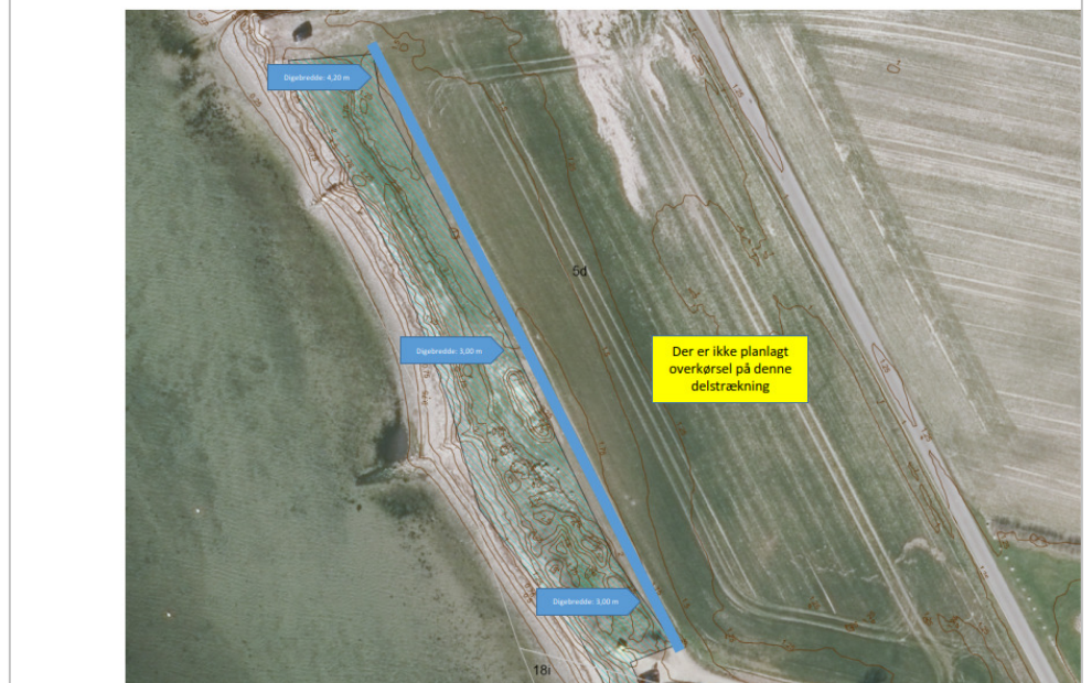
Kort B2 – Kort over delstrækning 2 med angivelse af kystbeskyttelses anlæggets placering med blå streg, samt markering af delstrækninger og højdekurver (brun streg) (udarbejdet af ansøgerrepræsentant).
