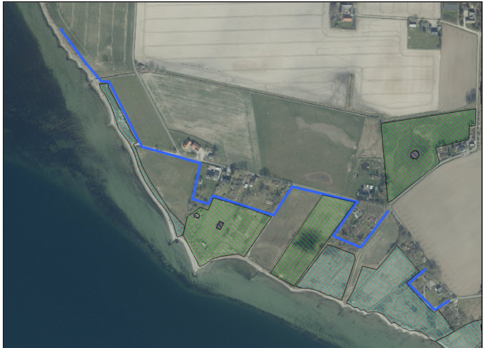
Figur 3. Oversigtskort – Placering af kystbeskyttelses anlæg i forhold til § 3 naturområder. Blå streg – kystbeskyttelses anlæg, grøn skravering – §3 beskyttet eng og lys blå skravering = § 3 beskyttet strandeng.
