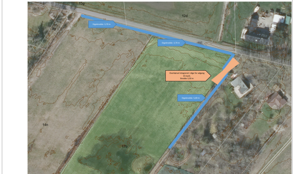
Kort B5 – Kort over delstrækning 10+11 med angivelse af kystbeskyttelses anlæggets placering med blå streg, placering af overkørsel (orange/brun markering) samt højdekurver (brun streg) (udarbejdet af ansøgerrepræsentant).
