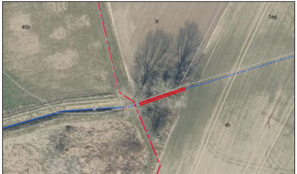
Billede 2 Matrikelkort over projektet. Den røde markering viser det rørlagte vandløb der ønskes åbnet. Den røde stiplede linje er Guldborgsund Forsynings trykledning.
