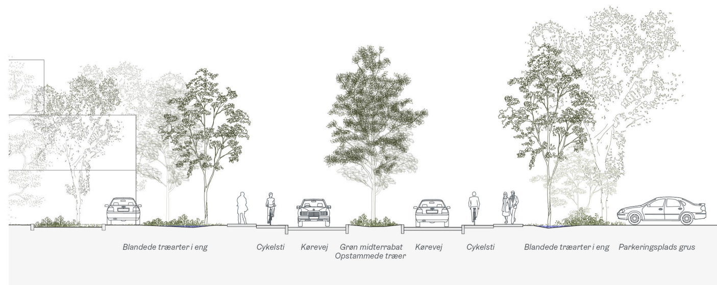
PRINCIPSNIT BEPLANTNING FEJØGADE - HAVNEPLADSEN - TØMMERGADE - STENGADE
